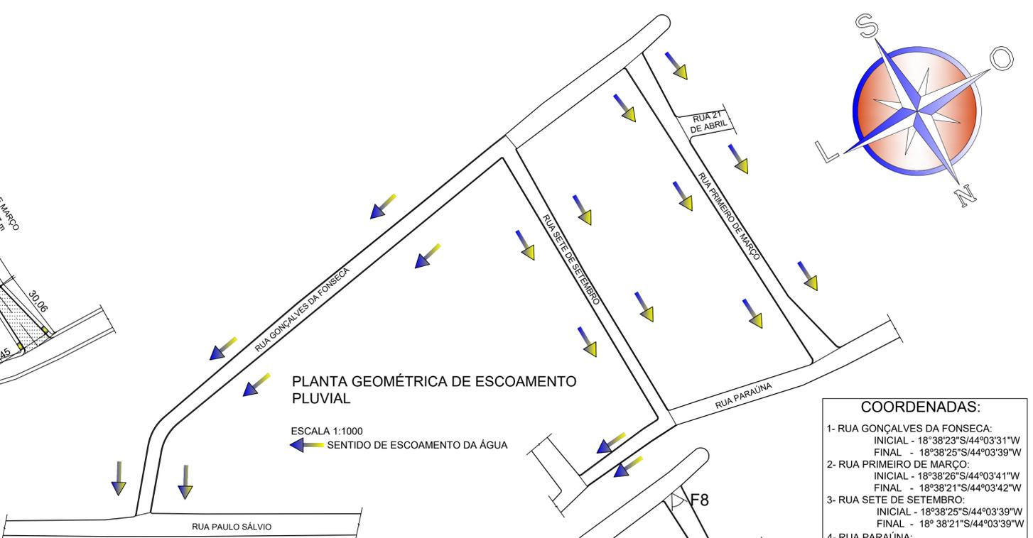
PLANTA GEOMÉTRICA DE ESCOAMENTO PLUVIAL
